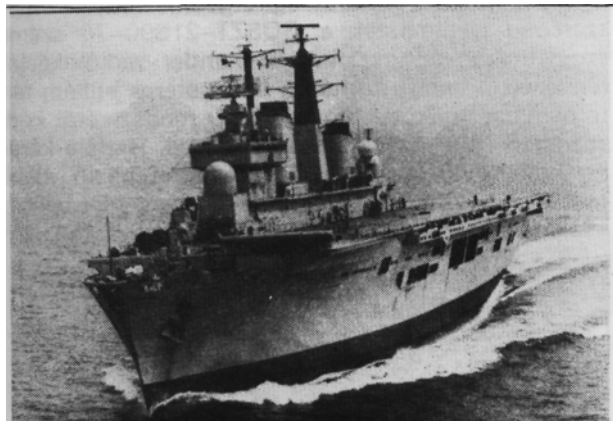
Rádiólokációs és speciális antennák az Invincible brit hadihajó fedélzetén
