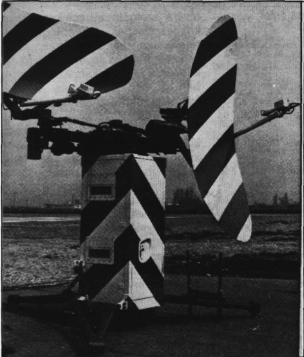
Repülőtéri leszállító rádiólokátor antennarendszere
